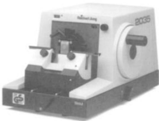
**Figura 1-** Fotografia de um micrótomo para cortes em resina (Retirado de Junqueira, Carneiro<sup>12</sup>)
